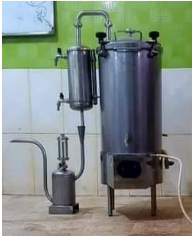
Figure n° 7 : Appareil D'hydro distillation(alambic)
