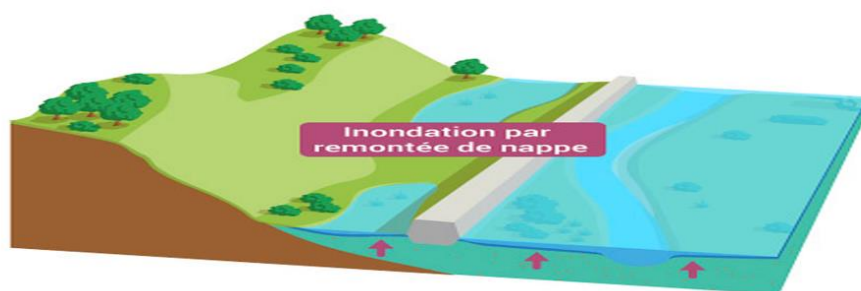
Figure 6. les inondations par remontée de nappe. (5)
