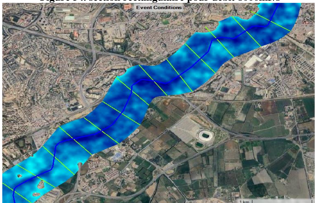
Figure 55. section rectangulaire pour débit 8000m 3 /s
