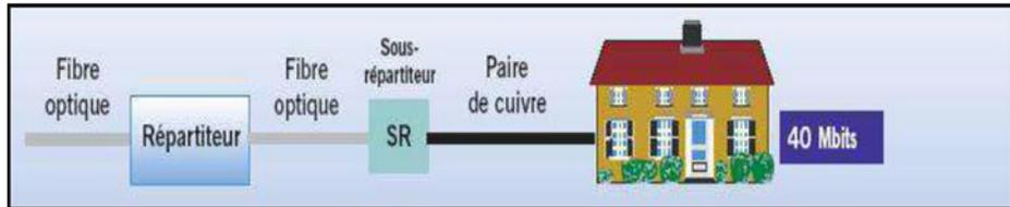
Figure I.8: distribution de Fibre jusqu'au cabinet
