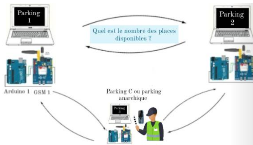
Figure 2.2: Schéma de communication entre trois parkings
