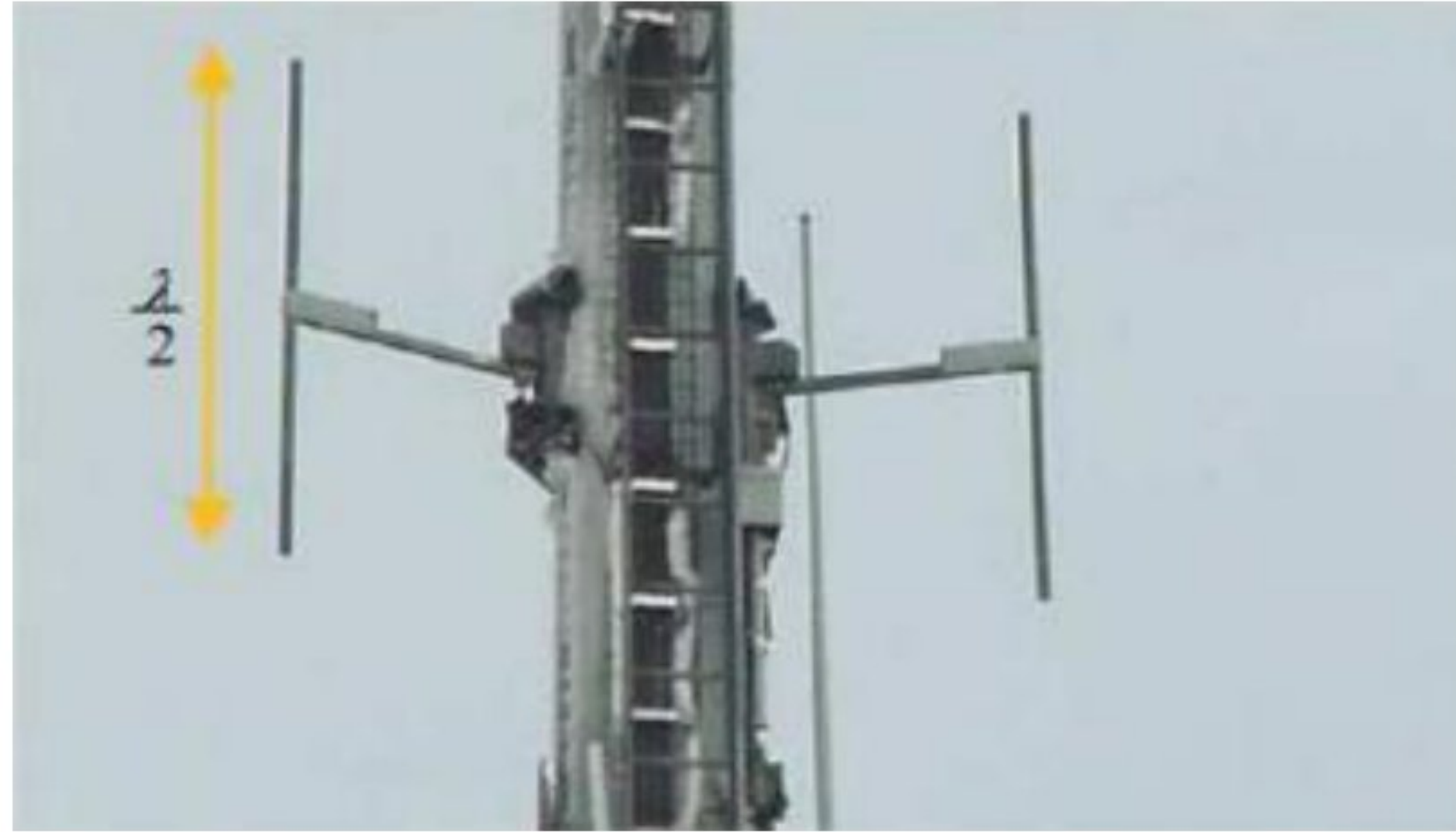
FIGURE 1.10. Dipôle a une longueur totale d'une demi-longueur d'onde
