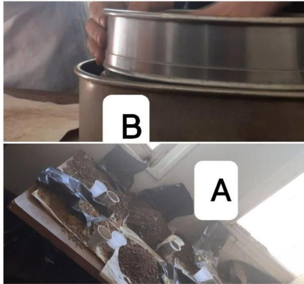
**Figure 9 : A-Séchage du sol B- mise en gobelets de l'échantillon (Origine 2022)**
