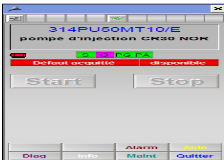
Figure V.15. Faceplate du pompe
