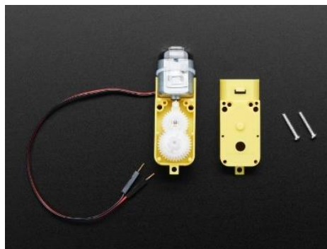
Figure 2.8. Moteur à courant continu avec réducteur.
