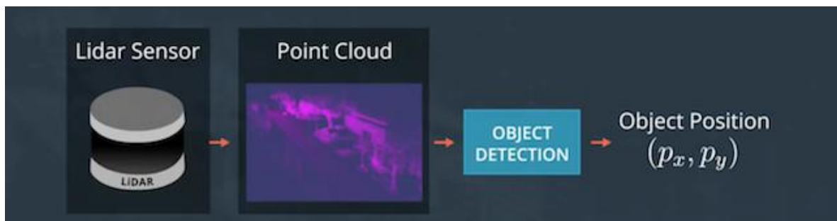
Figure 2.13. Estimation de position avec un Lidar.
