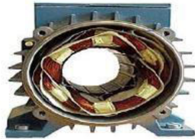
Figure 1.2: Stator d'une machine asynchrone triphasé
