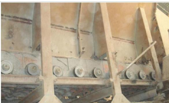
(Figure 2.2) : Alimentateur à tablier métallique.
