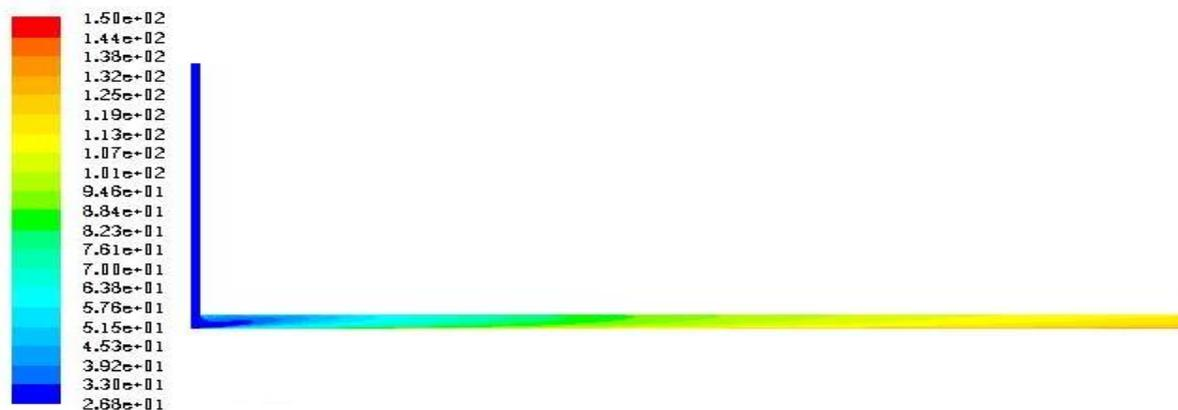
**Figure IV.17.** le contour de temperature ( $^{\circ}$ C), Structure 1, la vitesse de rotation est 80000 RPM, Le modèle de turbulence  $k-\epsilon$  est utilisé
