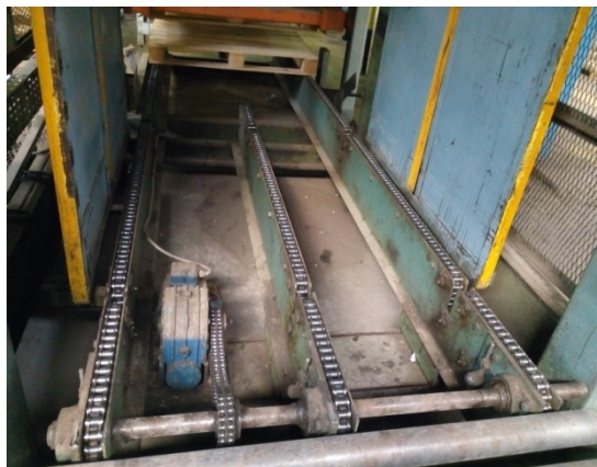
Figure 2.16. Emplacementdumoteur de la Chaine de transmission des palettes.
