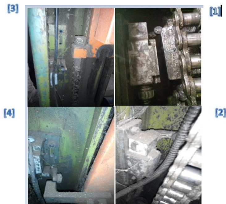
Figure 2.9. Emplacementdes quatrecapteurs de position mécanique.
