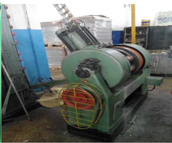
Figure 1.12. La machine de sertissage (vue partiel) Figure 1.13. La machine de sertissage (vue global).
