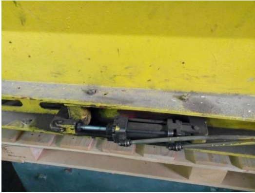
Figure 2.23. Emplacement du vérin sur l'élévateur de la pile des palettes vides.
