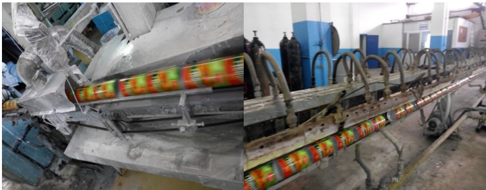
Figure 1.10. la machine de vernissage. Figure 1.11. le passage au four.
