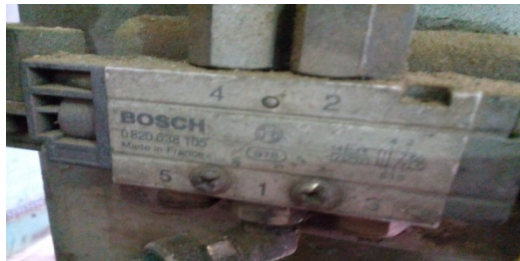
Figure 2.21. Emplacement du premier distributeur pneumatique bistable.
