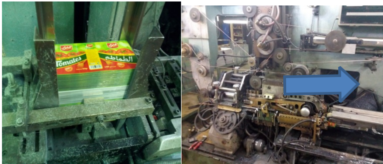
Figure 1.7. L'emplacement des plaques sur la soudeuse. Figure 1.8. La machine soudeuse.
