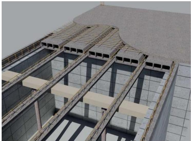
Fig. 2 : Coupe de la dalle en corps creux.
