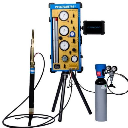
Figure I. 1: Le pressiomètre.
