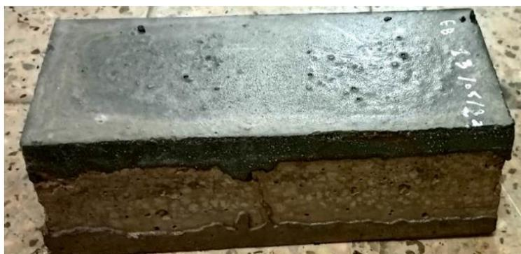
Figure2.20 : Application du mortier de réparation sur les dalles.
