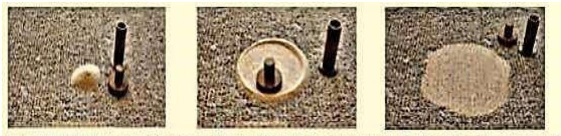
Figure 1.9: méthode de la tache de sable.
