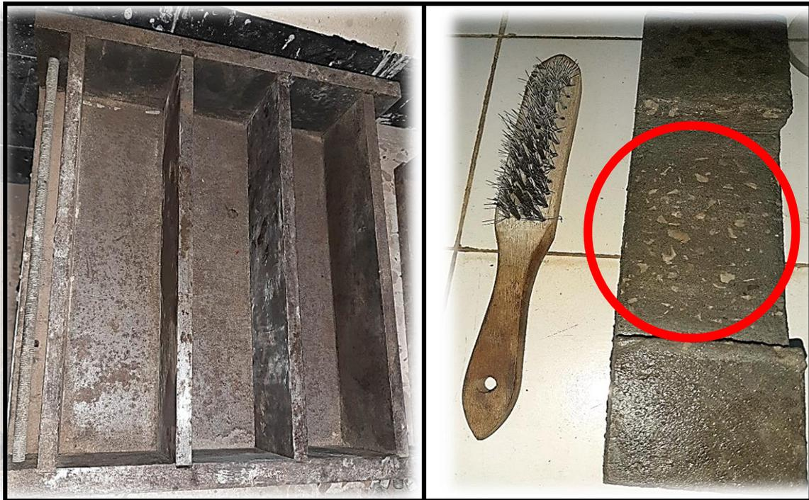
Figure 2.16 : préparation des éprouvettes en béton 7\*7\*28
