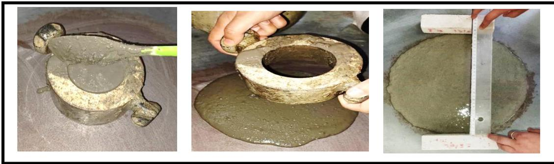
Figure 2 .24 : étalement du mortier autoplaçant de réparation.
