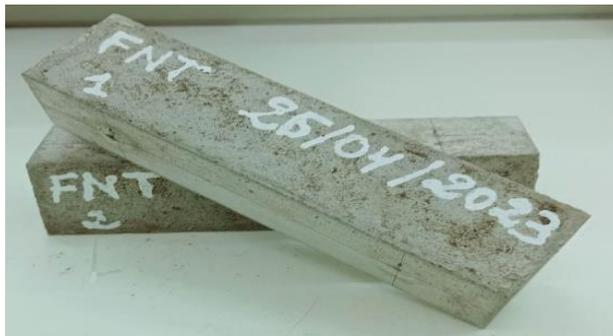
Figure 2.22 : éprouvettes  $4 \times 4 \times 16$ .
