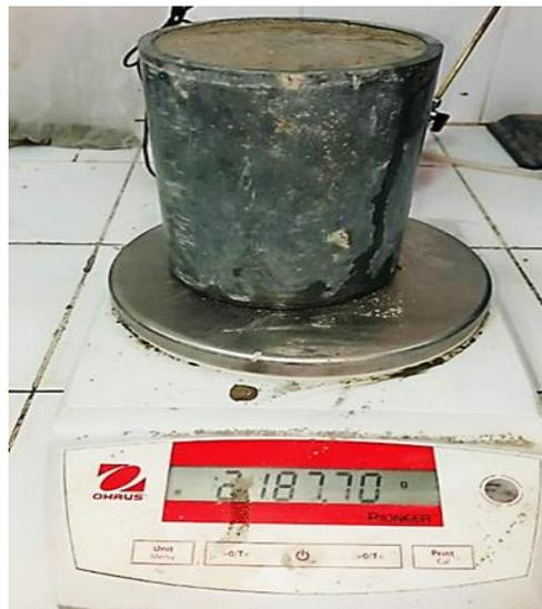
Figure2.25: masse volumique des mortiers.
