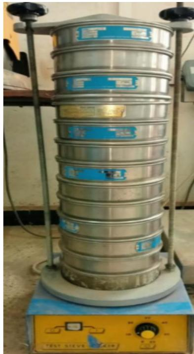
Figure2.6 : analyse granulométrique.
