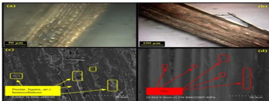
Figure 1.18 : fibre palmier dattier en contact avec le ciment.
