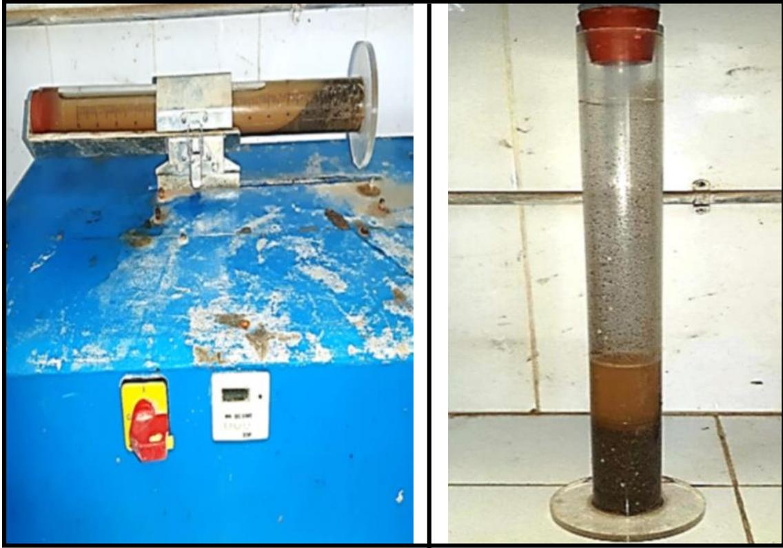
Figure 2.5 : équivalent de sable.
