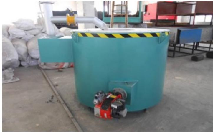
FIGURE 3.2 – Four utilisé pour la fusion
