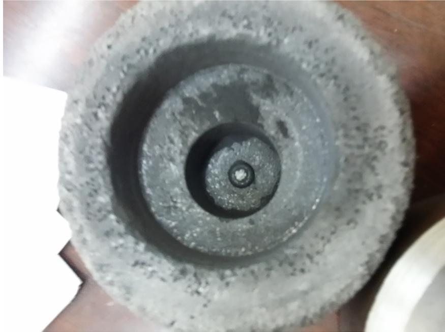
FIGURE 3.5 – Moule en graphite avec un orifice de de 20mm de diamètre au milieu
