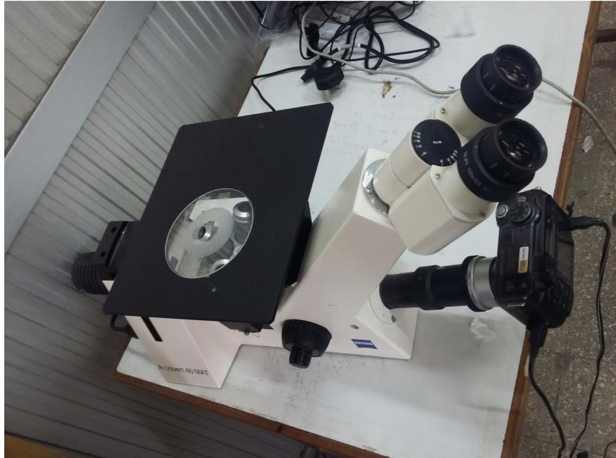
FIGURE 3.16 – Microscope Optique Zeiss Axiovert 40MAT utilisé pour la mesure du SDAS
