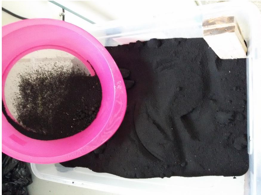
FIGURE 3.8 – Sable près à l'emploi et être compacté pour formé un moule
