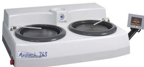
FIGURE 3.15 – Polisseuse électrique
