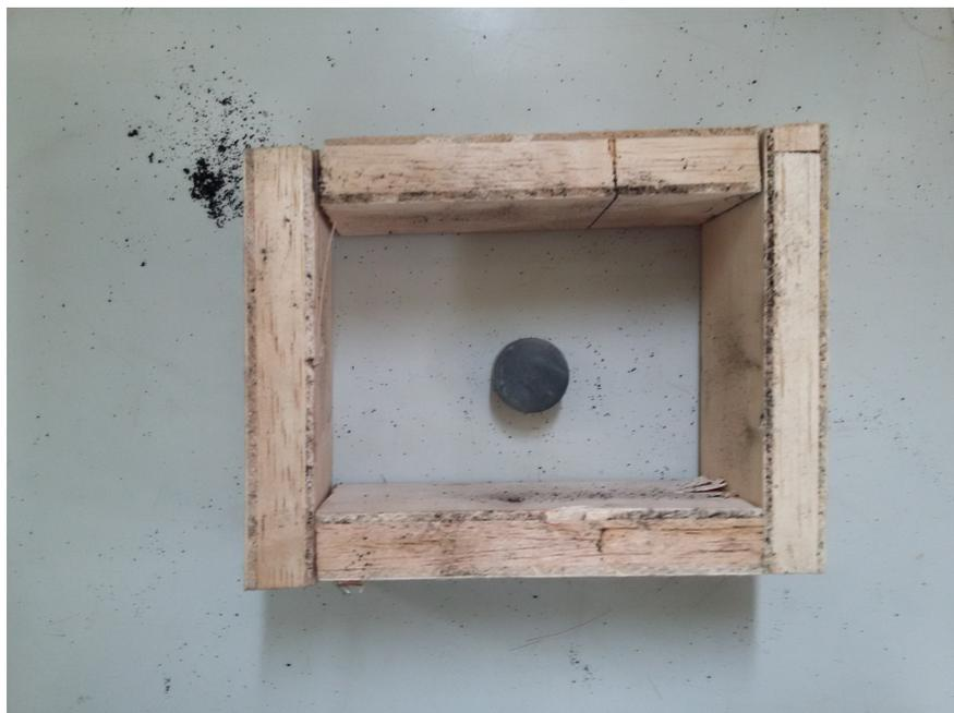
FIGURE 3.9 – Socle en bois du moule en sable de forme rectangulaire, avec son empreinte près à être rempli de sable de vert
