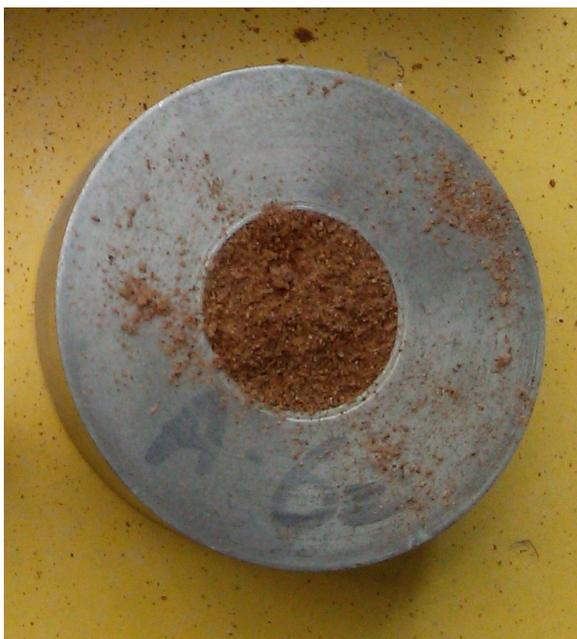
FIGURE 3.6 – Moule métallique en acier A60 avec un orifice de de 20mm de diamètre au milieu
