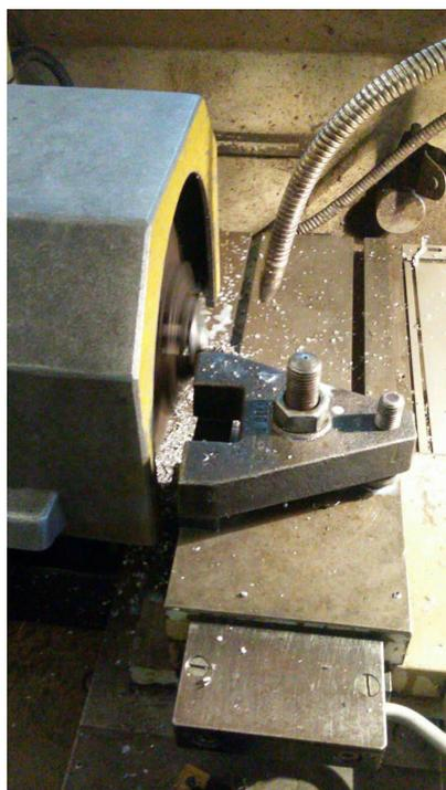
FIGURE 3.14 – Dressage des échantillons à l'aide d'un tour
