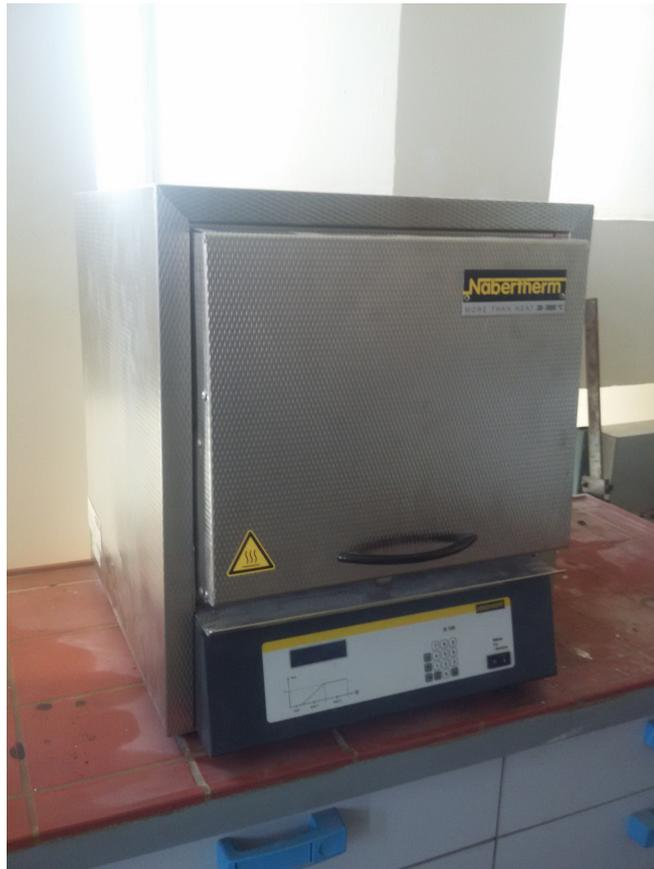
FIGURE 3.12 – Four à moufle utilisé pour la fusion des alliages d'aluminium
