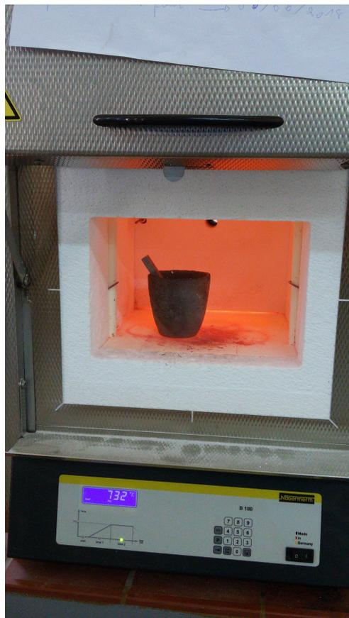
FIGURE 3.13 – Mis à fusion des débris d'alliages d'aluminium dans un creuset en graphite
