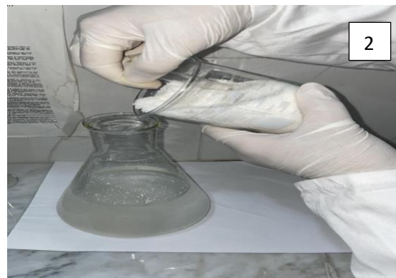
Fig 16 : Peser 25g de NaCl et diluer dans 100ml d'eau distillée (Photos originale, 2023).
