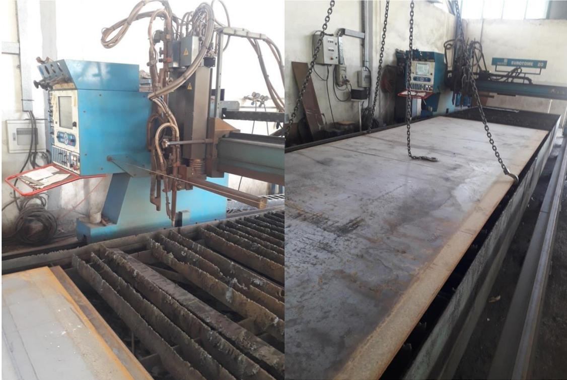
**Figure 3. 1: Découpage et Perçage des tôles par la machine EUROTOME.20.**
