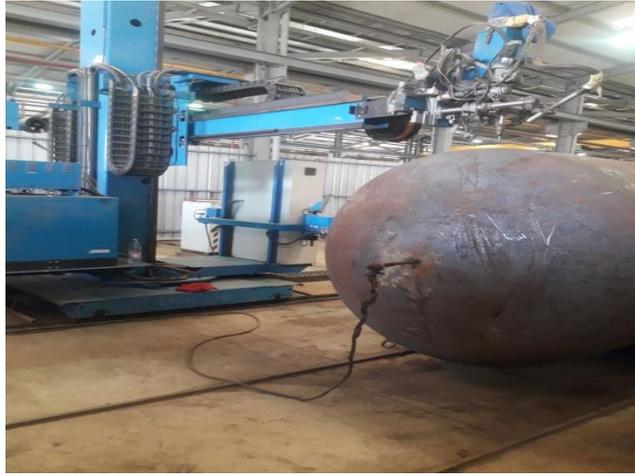
**Figure 3. 4: Le Soudage automatique sous-flux électro-conducteur solide par la machine de potence de soudage CB-MATIC LM 32-33. [Source MAGI].**
