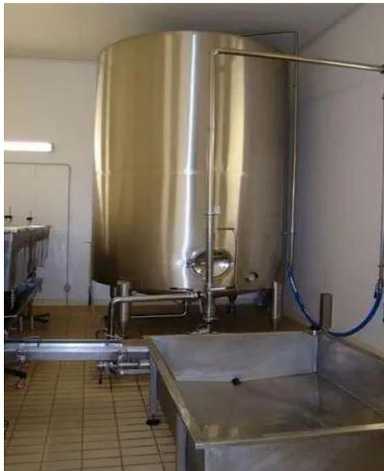
**Figure 1. 1: Réservoir vertical en acier inoxydable pour le stockage du lait.**
