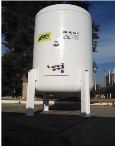
Figure 1. 7: Réservoir GPL 2,5 Tonnes. [Source MAGI]
