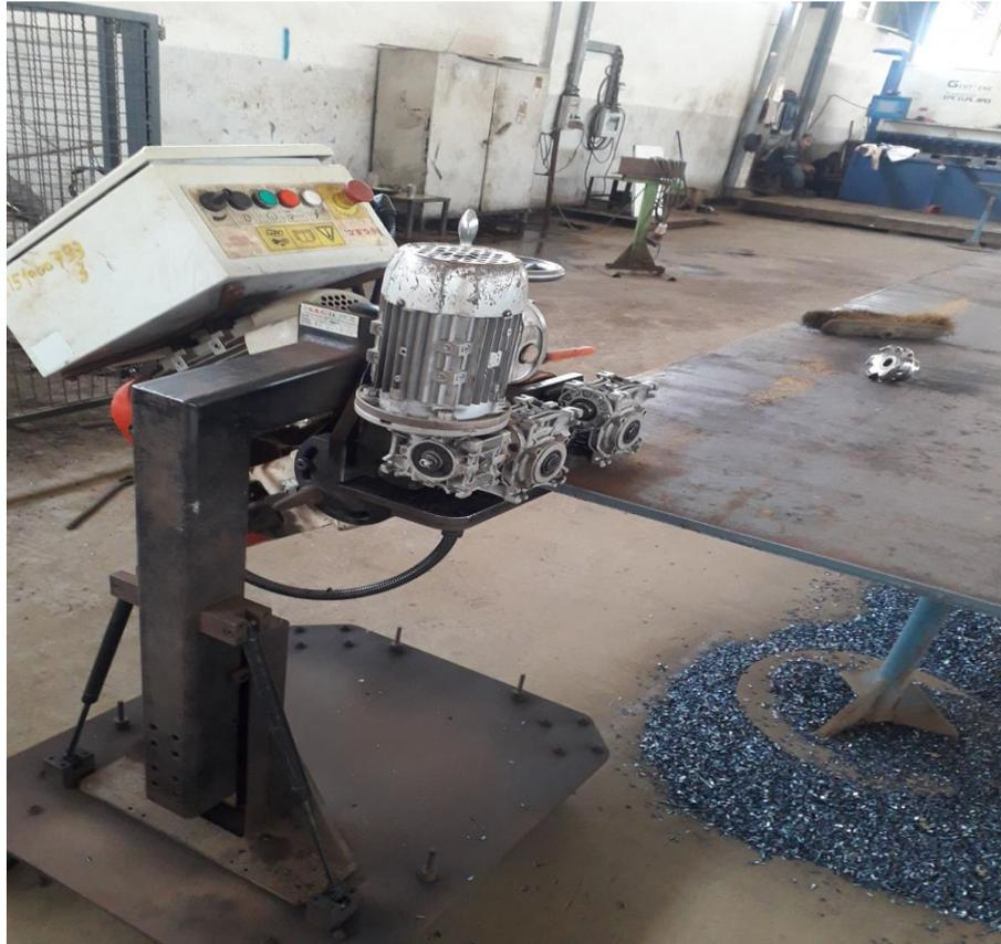
Figure 3. 2: Chanfreinage des tôles [Source MAGI].
