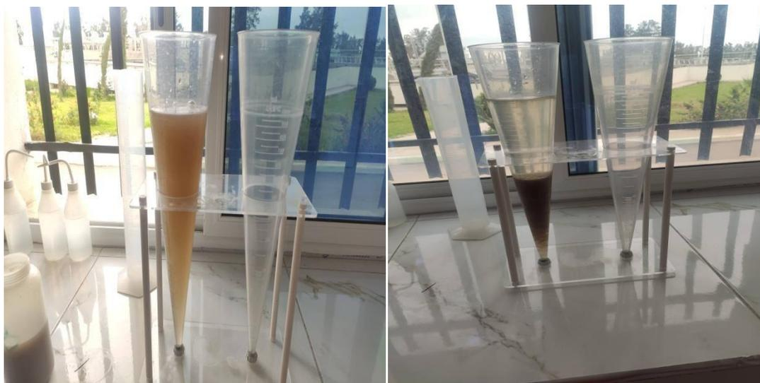
**Figure 4. 3: Cônes D'Imhof (Originale ,2023) Les Matières En Suspension (MES)**
