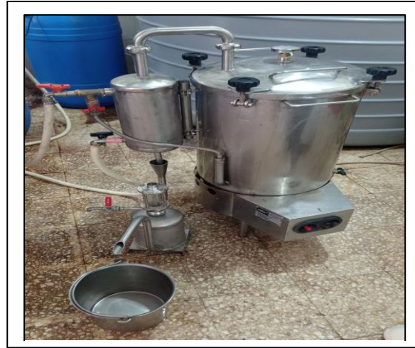
Figure 9: Extraction de l'huile essentielle par hydrodistillation.
