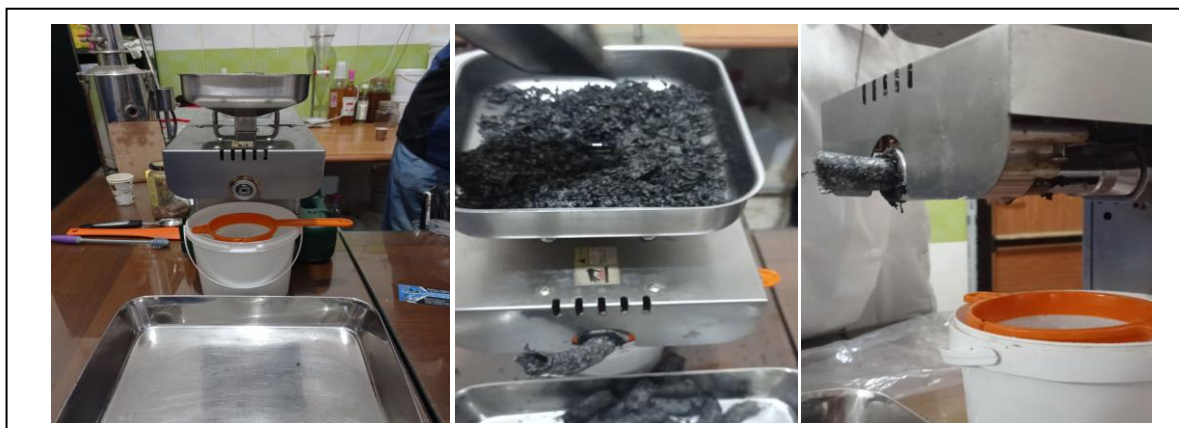
Figure 10 : Extraction d'huile végétale des graines de la nigelle par l'appareil de la presse à froid.
