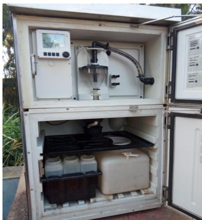
**Figure N°9** : Préleveur automatique de la STEP
