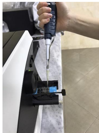
Figure 27 : Remplissage d'une chambre de la lame LEJA avec de la semence diluée.
