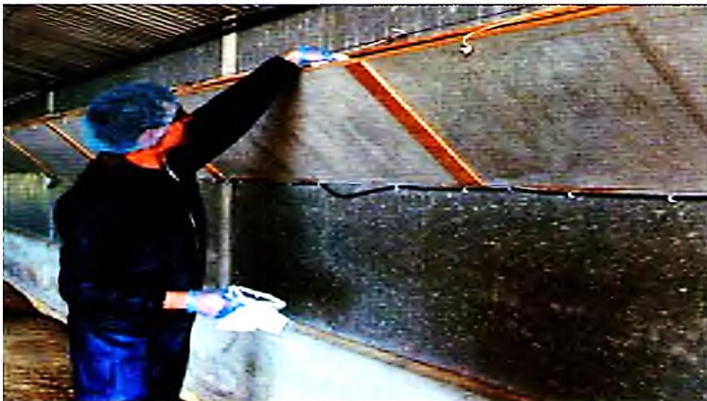
Figure 11: Contrôle des salmonelles des entrées d'air après nettoyage-désinfection avec chiffonnette (Guérin et al. , 2011).
