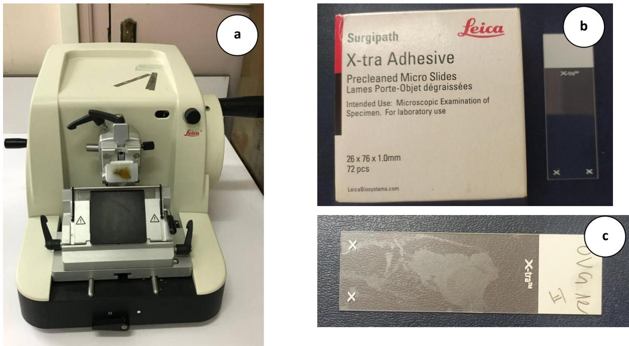
**Figure 15 :** Microtome avec bloc paraffine (a) ; une lame silanisée (b) ; lame blanche (c) (photo personnel).
