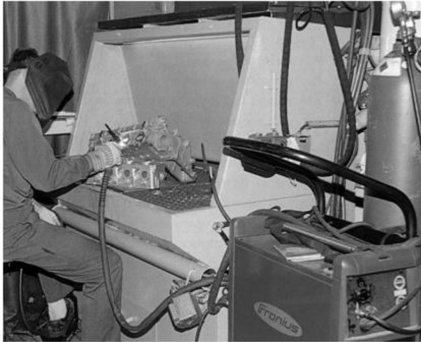
Figure 8 Réparation manuelle par soudage DC-ve TIG d'aluminium de fonderie à l'aide de gaz de protection à l'hélium.
