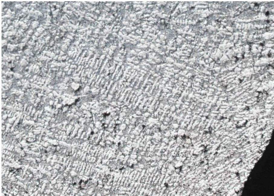
Figure 35 Microstructure de la ZAT de T3, X25
