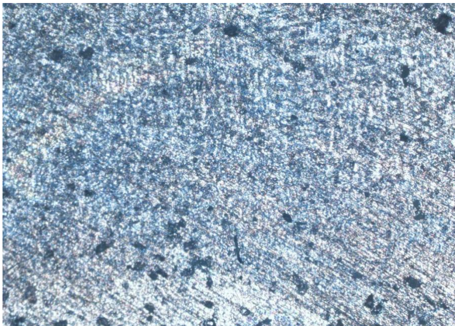
Figure 40 Microstructure de la ZAT de M1, X25
