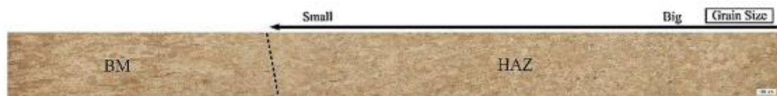
Figure 11 Évolution des grains de la ZAT à la MB. [22]
