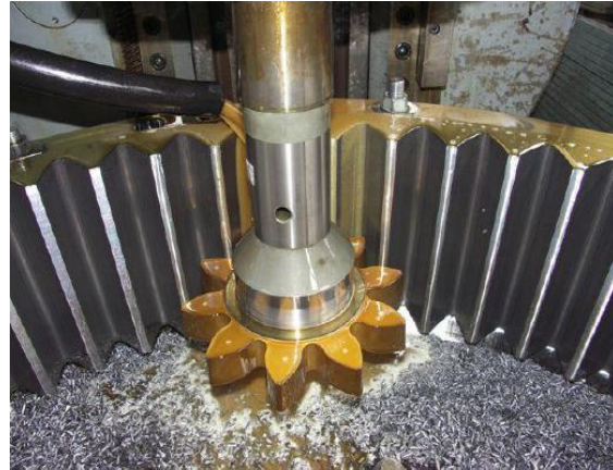
Figure II.11 : Usinage de denture intérieure par outil pignon.
