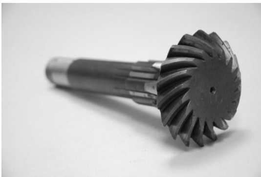
Figure II.12 : Outil pignon à denture hélicoïdale, images HHM
