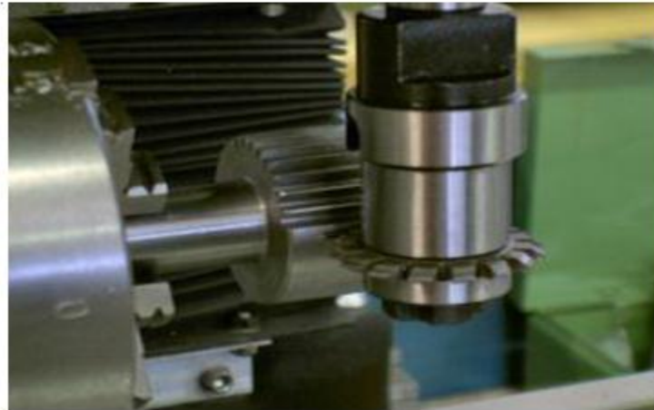
Figure II.2 : Exemple de taillage d'une roue par fraise-module, Image Sideméca [7]
