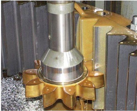
Figure II.11 : Usinage de denture intérieure par outil pignon.
