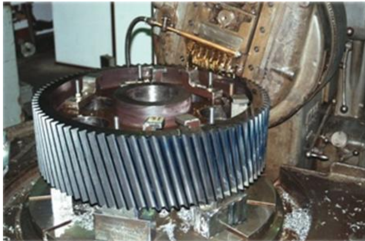
Figure II.7 : L'outil sur la machine est incliné à droite, la roue usinée est à dentures à gauche.
