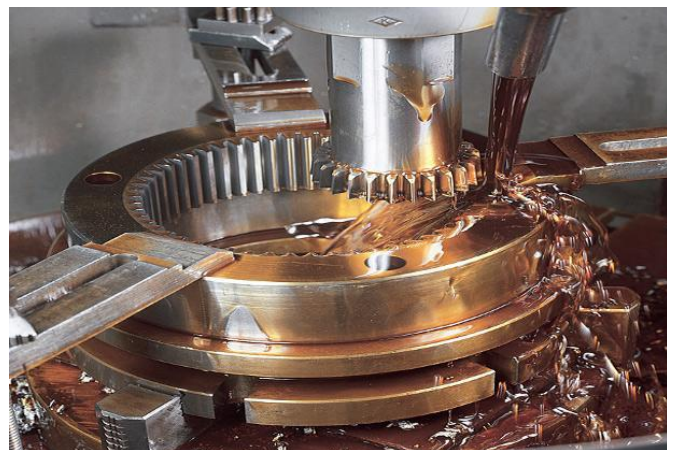
Figure II.13 : Usinages de dentures intérieures par outil pignon, images cvmpp [14]
