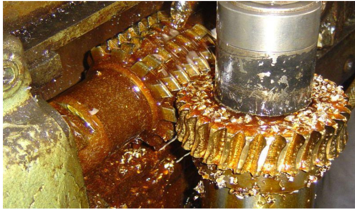
Figure II.14 : Exemple de taillage par fraise-mère, image AMMI [15].
