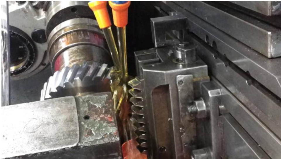
Figure II.5 : Exemple de taille par outil crémaillère, source Chauvin-Mécagaphic [9]
