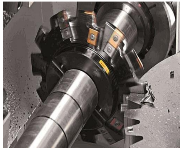
Figure II.3 : Fraise-disque à grande productivité, Coromil 170 de SANVIK COROMANT [8]
