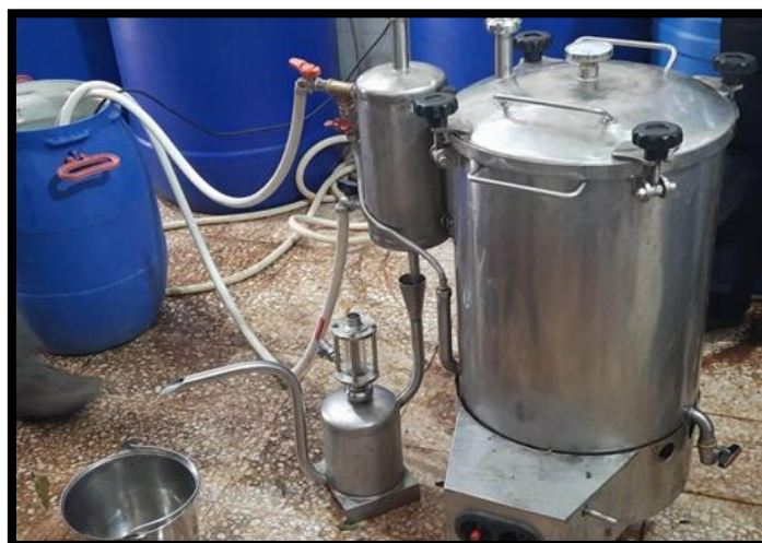
Figure 3 : L'appareil de l'hydro distillation (originale, 2023).
