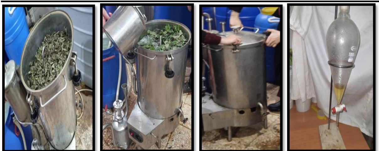
Figure 4: Procédés de la technique d'extraction de l'huile essentielle (Originale, 2023).
