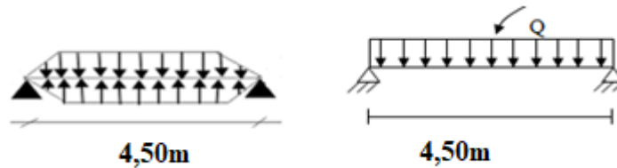
Figure VI. 4: Répartition des charges sur les poutres
