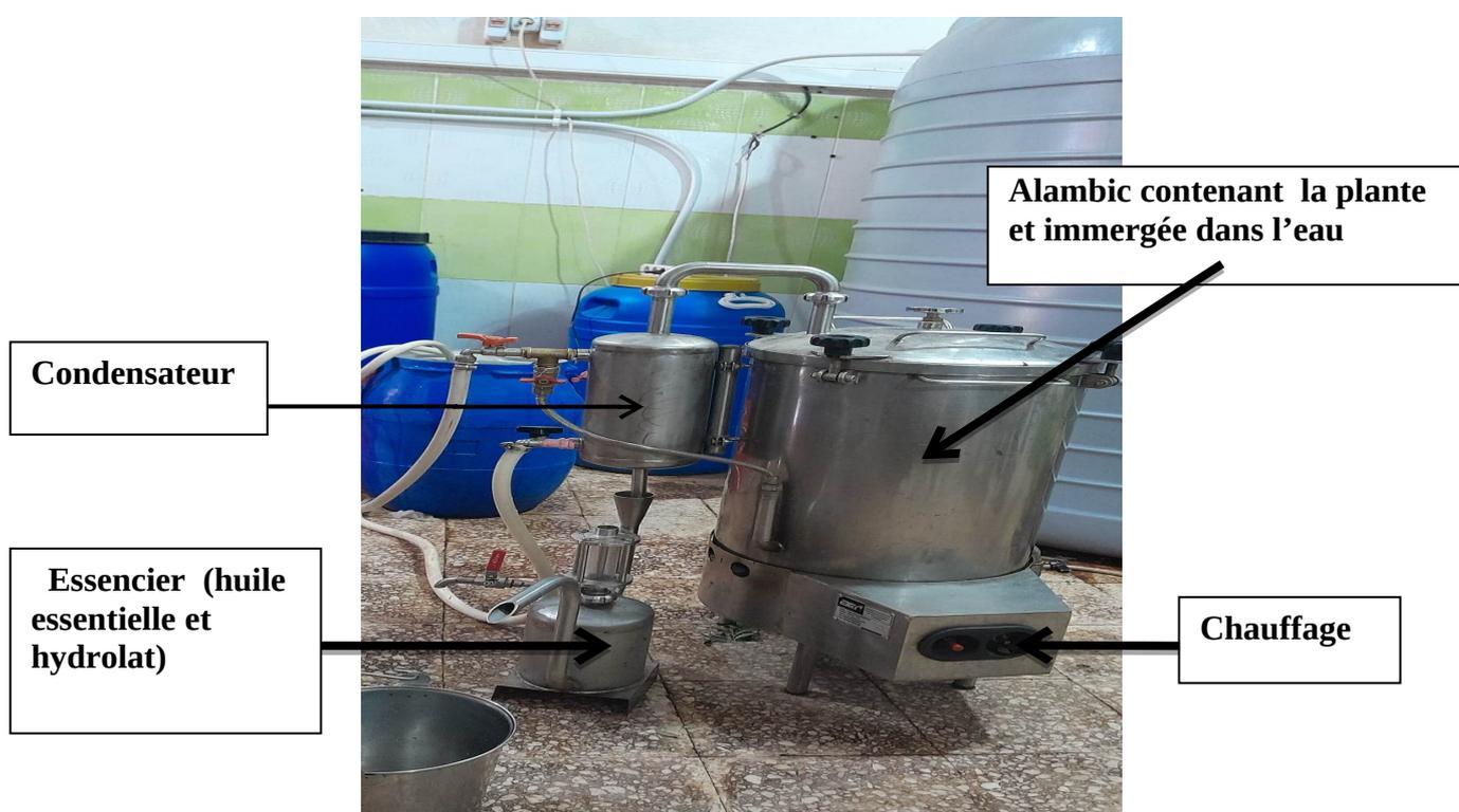
Figure 6: appareil d'extraction
