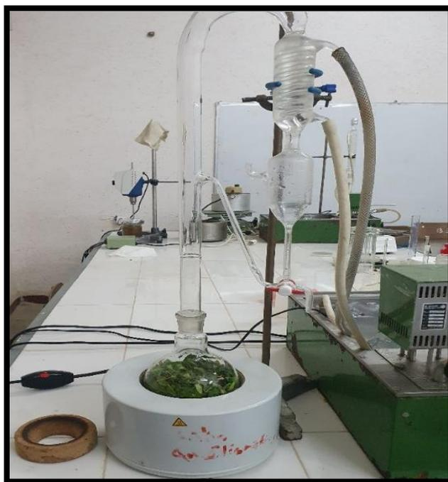
Figure n° 08: hydro distillateur de type Clevenger (originale 2023)
