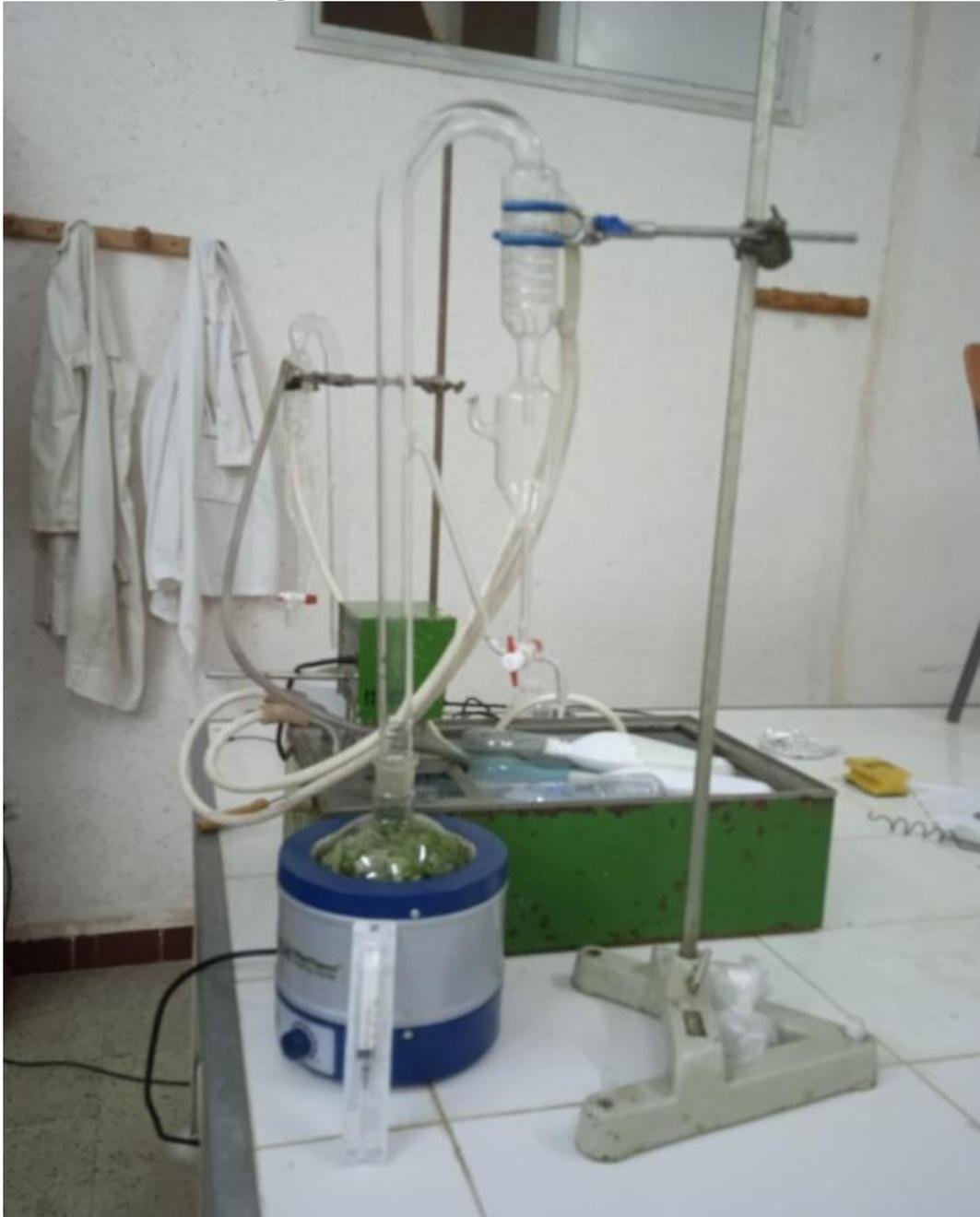
**Figure 14 :** Appareil d'hydrodistillation (Clevenger)
