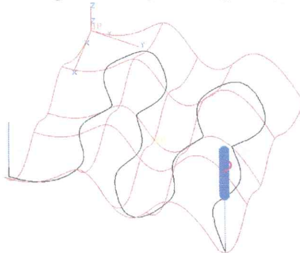
Figure 24 : Simulation de trajet d'outil dans un plan de la surface.
