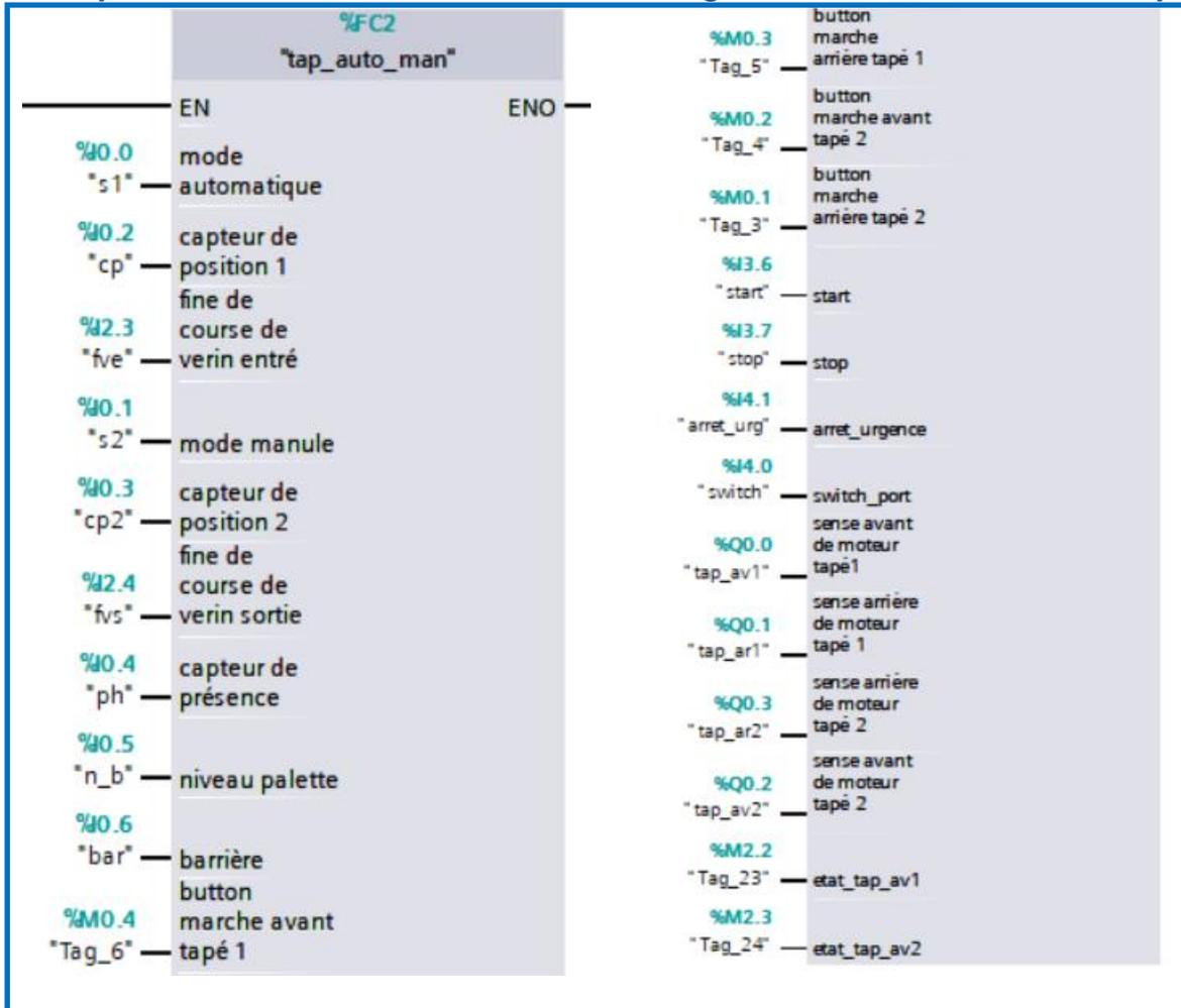
Figure 4.4 : Bloc fonction de convoyeur.
