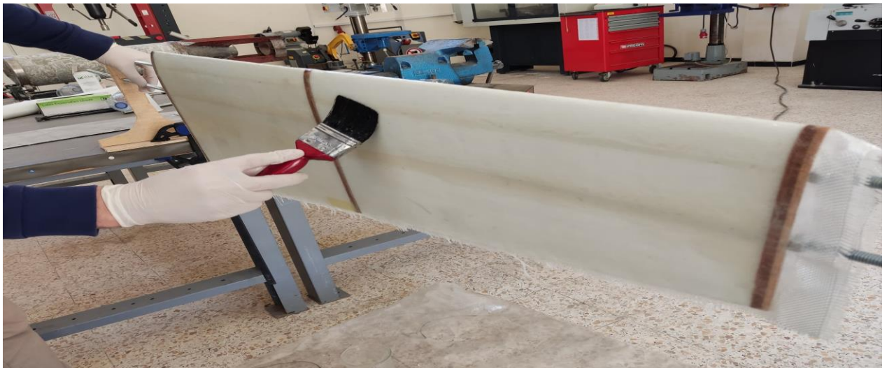
Figure II.19. Revêtement de la demi aile
