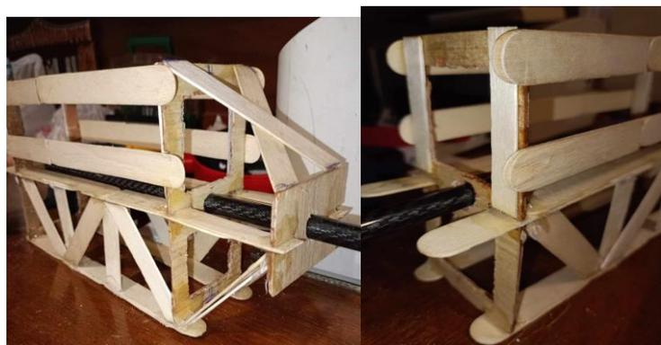
**Figure IV.7:** Construction de la structure interne de fuselage .
