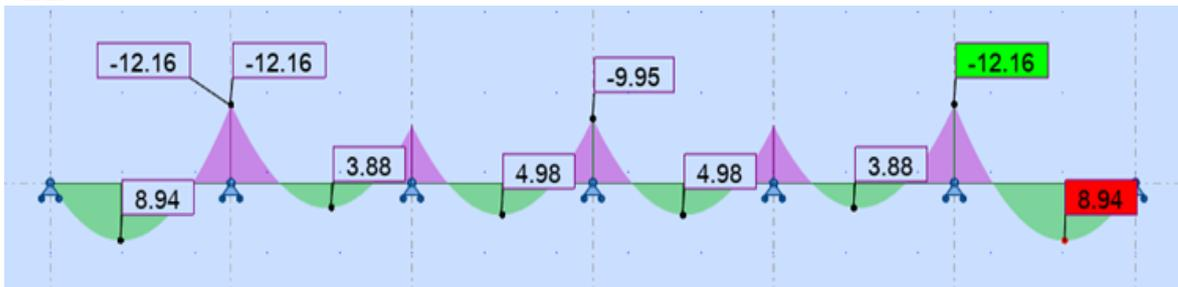
**Figure.III.14 :** Diagramme des moments fléchissant ELS
