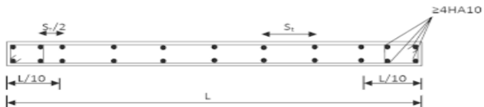
Figure VI. 7: Disposition des armatures verticales dans le voile.
