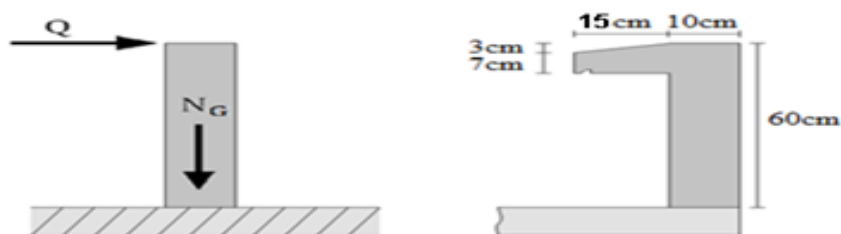
Figure III.1 : Schéma statique de l'acrotère.
