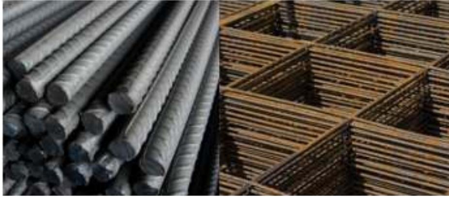
L'acier est un alliage métallique ferreux, qui est d'ailleurs principalement composé de fer, l'élément additionnel étant le carbone, qui n'est présent qu'à l'état de traces infimes. Selon les aciers, la teneur en carbone est comprise entre environ 0,005 % et 1,5 % en masse. Elle monte très rarement jusqu'à 2 %.
