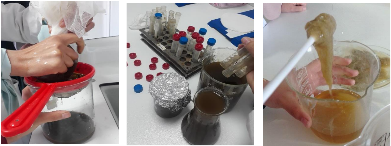
Figure 12 : Les étapes de filtration de l’alginate de sodium
