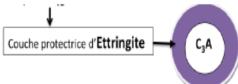
Figure 0-1. Schéma montrant la couche protectrice d'ettringite [22]
