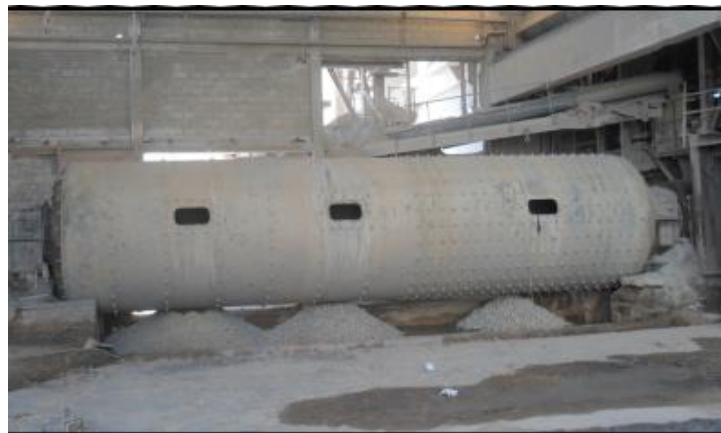
Figure 0-2. Photographies montrant (a) : Atelier de concassage du calcaire ; (b) : Broyeur de la matière première
