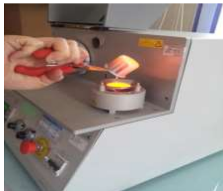
Figure 02: Image de la mis en forme de perle
