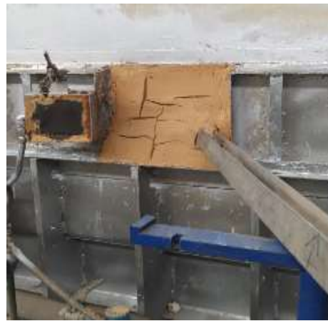
(d) Mauvaise étanchéité, perte de pression
