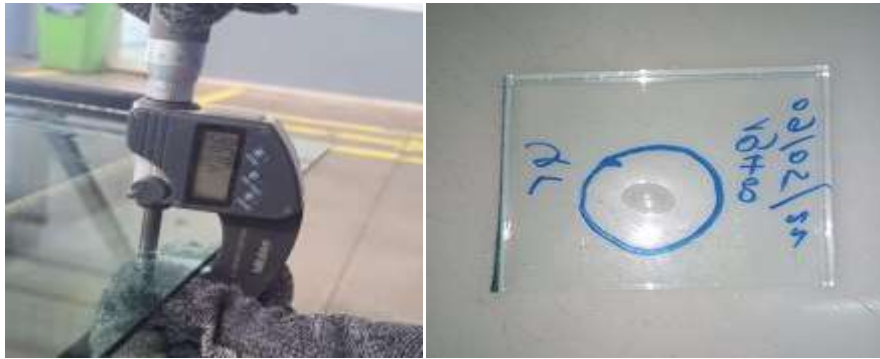
Figure III.2: Photo présentant un échantillon du défaut (à droite) et son prélèvement (à gauche).
