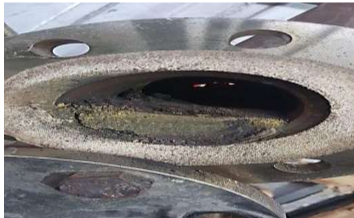
Figure IV. 09: Photo de l'accumulation de SnO 2 (PPN).
