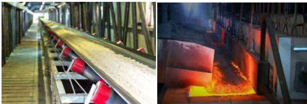
Figure II.9 : Transport de mélange vers le four [27].
