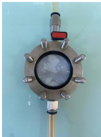
Membrane avant et après l'essai de filtration.
