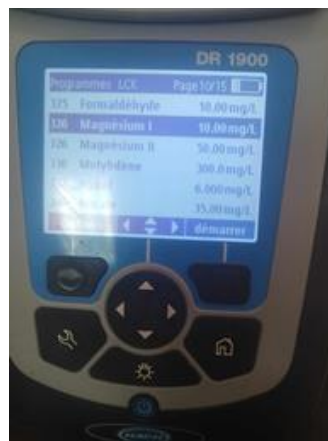
Figure 2.20 : Photo spectrophotomètre de type HACH DR 1900
