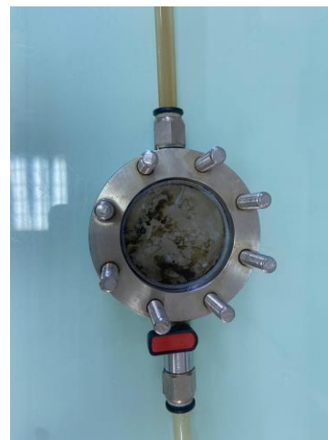
Membrane avant et après l'essai de filtration.
