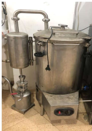
Figure 3.4 : Montage d'entraînement à la vapeur.
