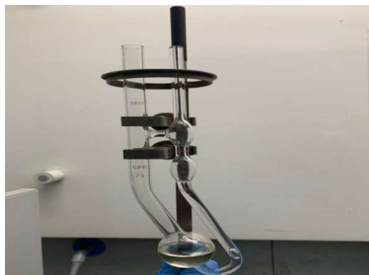
Figure 3.10 : photo de capillaire utilisé.
