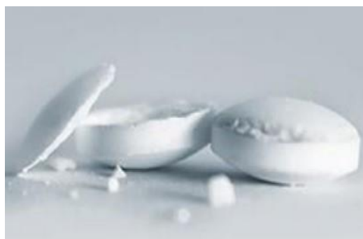
Figure III. 1: phénomené de décalottage des comprimés (18)
