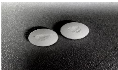
Figure III. 2: Effet de collage sur l'aspect des comprimés
