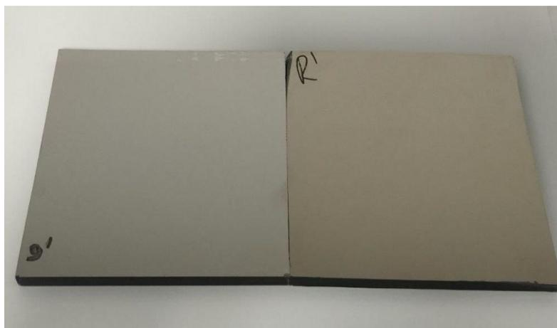
FigureV.1 : Photo montrant les échantillons de verre à couche non trempé avant et après le test de corrosion humide
