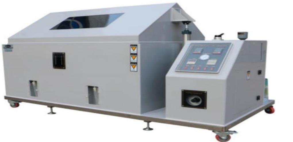
**FigureIV.5 : Photographie de l'appareillage du test brouillard salin Neutre**
