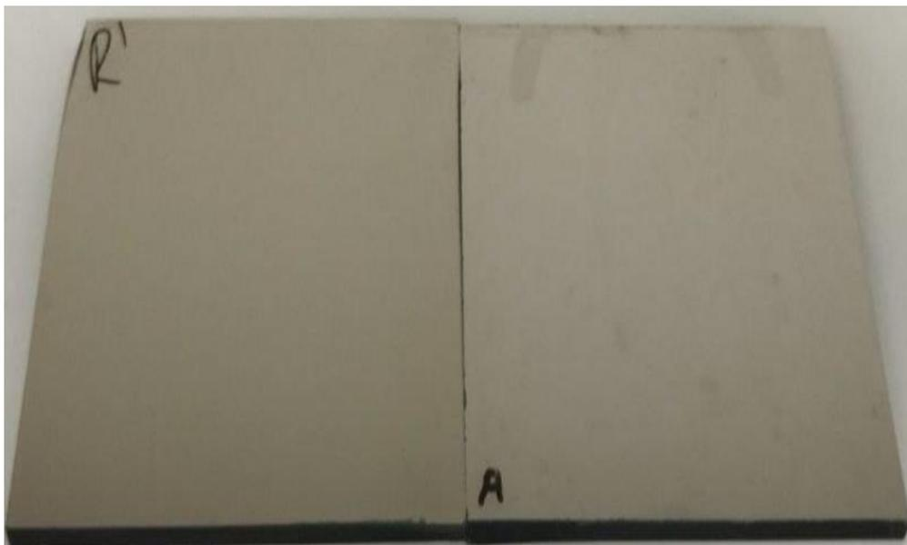
**FigureV.5 : Photo montrant les échantillons de verre à couche trempé avant et après test de brouillard salin**
