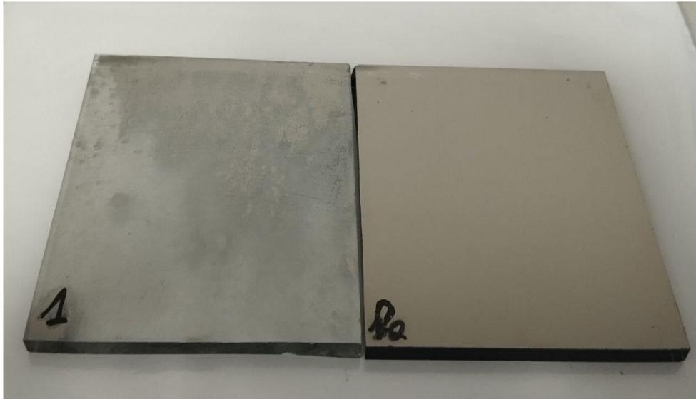
**FigureV.4 : Photo montrant les échantillons de verre à couche non trempé avant et après test de brouillard salin**
