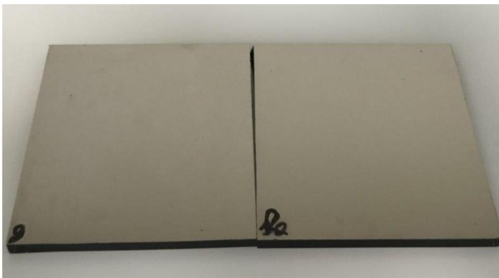
**FigureV.2 : Photo montrant les échantillons de verre à couche trempé avant et après test corrosion humide**
