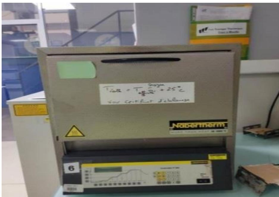
**Figure IV.1 : Photo montrant le four de la trempe thermique**
