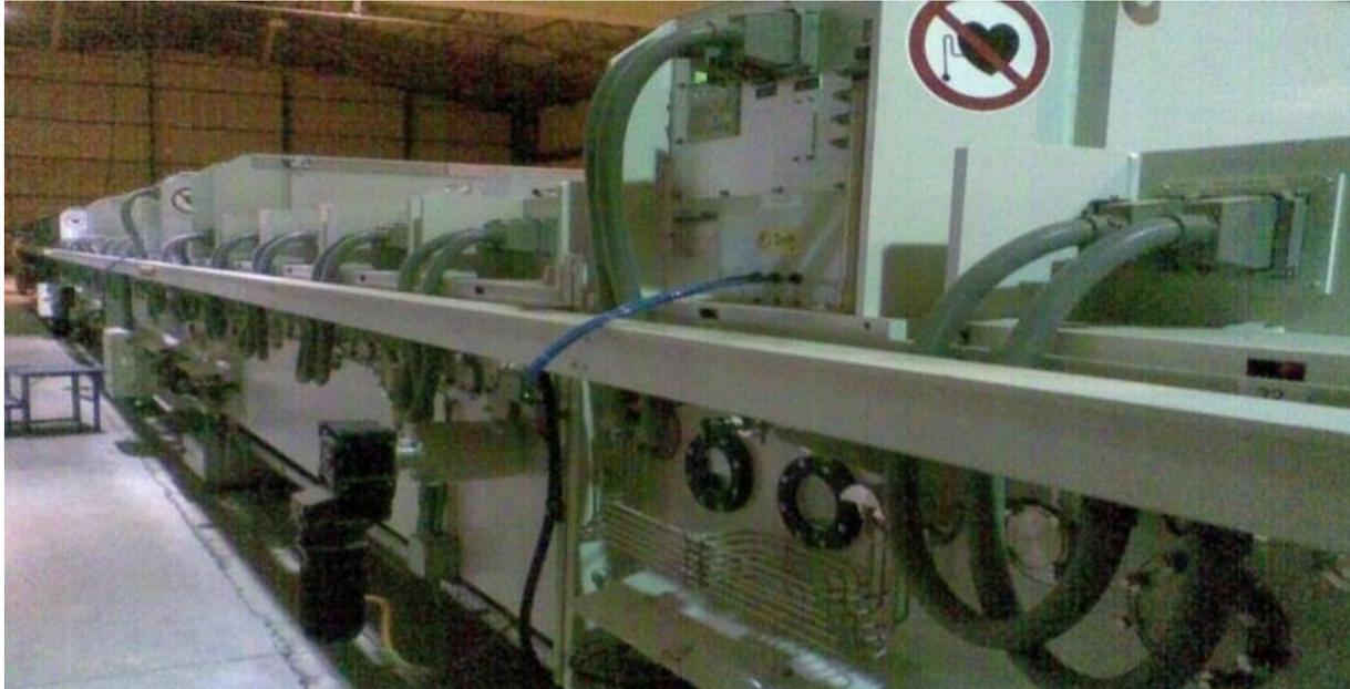
**FigureIII.4 : Photo montrant la zone de la partie de pulvérisation cathodique**
