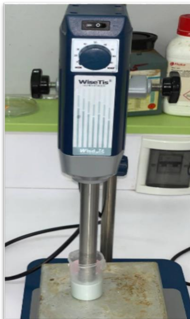
Figure 4.4 : Préparation de l'émulsion buvable à l'aide d'un homogénéisateur.
