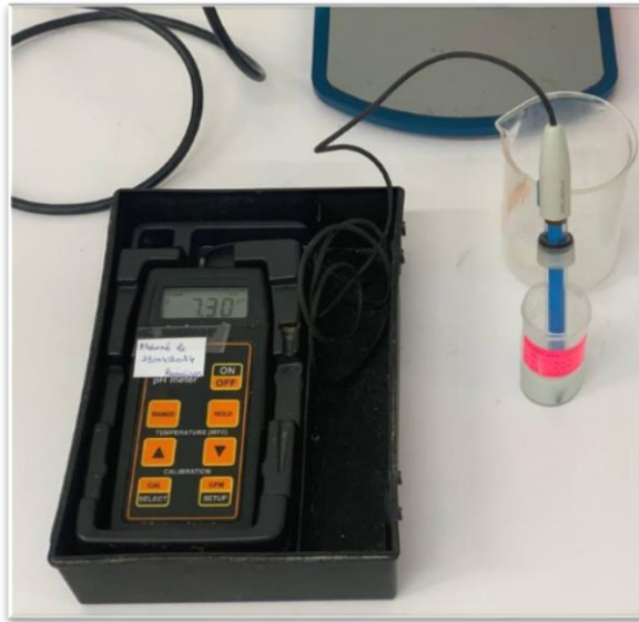
Figure 4.5 : pH-mètre de type HI8424N - HANNA INSTRUMENTS.
