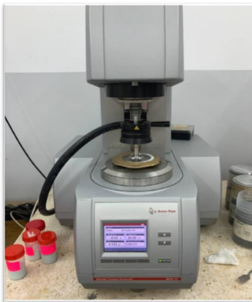
Figure 4.3 : Rhéomètre ANTON PAAR Modular Compact Rhéomètre MCR 302.
