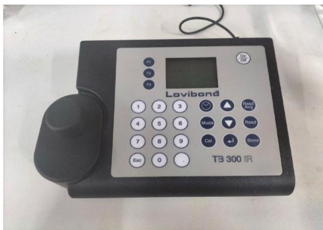
Figure 2.3 : Turbidimètre TB 300 IR.
