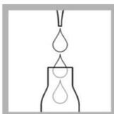
7. Pipetter lentement 0.2 mL de solution D.
