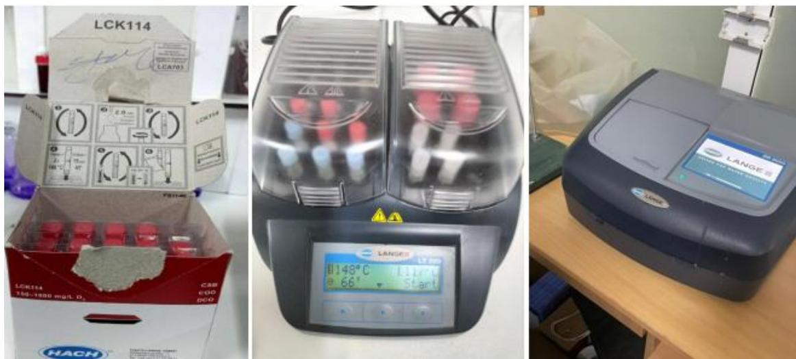
Figure 2.4 : kit DCO LCK114, thermostat LT200, spectrophotomètre DR6000.
