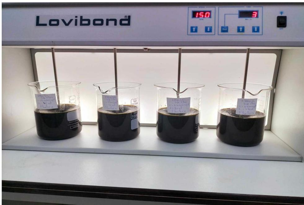
**Figure 2.8** : Essais de Jar test.
