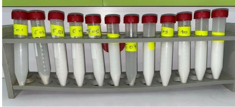
Figure 5.6 : Images numériques des 12 formulations après centrifugation (de gauche à droite essai 1,2,3,4,5,6,7,8,9,10,11,12) (5000 tours/min pendant 20 min, 25 °C)
