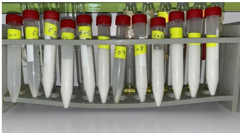
Figure 5.7 : Images numériques des 12 formulations après centrifugation après 30 jours de stockage à T° ambiante (de gauche à droite essai 1,2,3,4,5,6,7,8,9,10,11,12) (5000 tours/min pendant 20 min, 25 °C).
